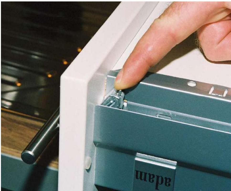
Bild 21.1. Demontage Arretierung von der Front wegdrücken.
