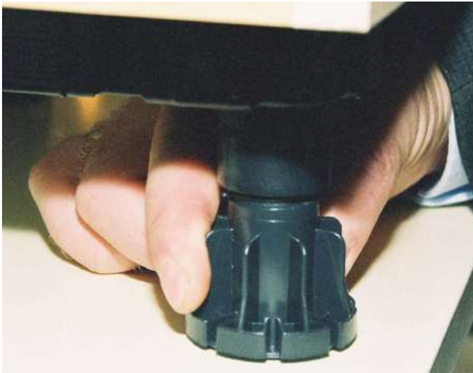
Bild 1. Sockelfuß in Sockelgleiter stecken.
