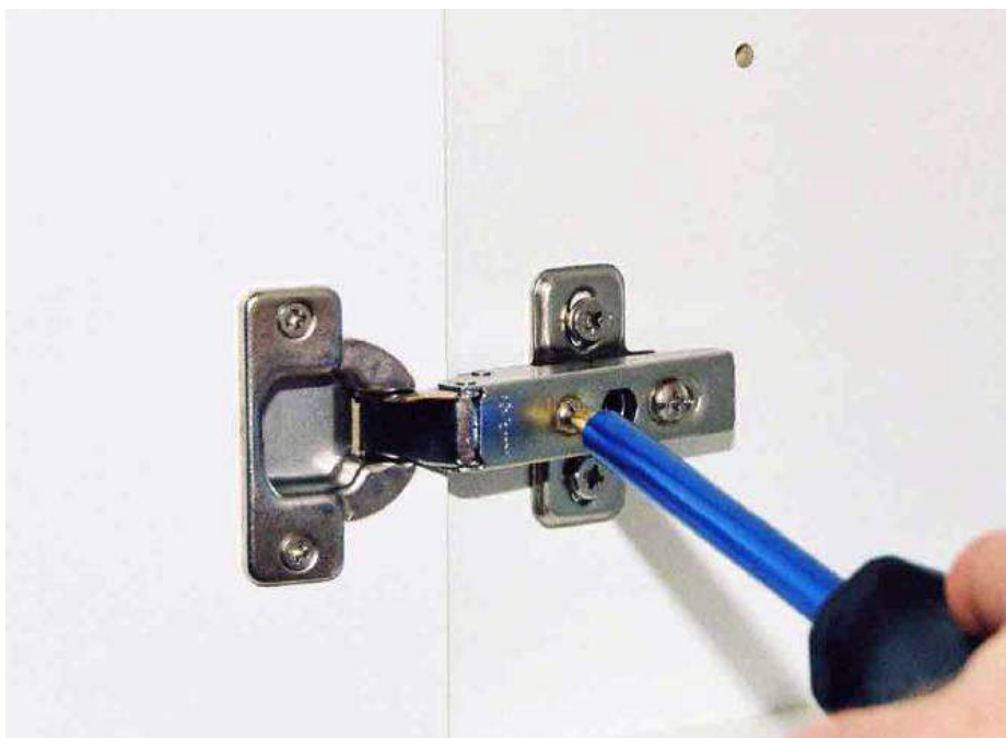
Bild 14.2. Seitenverstellung des Gelenkbandes.
