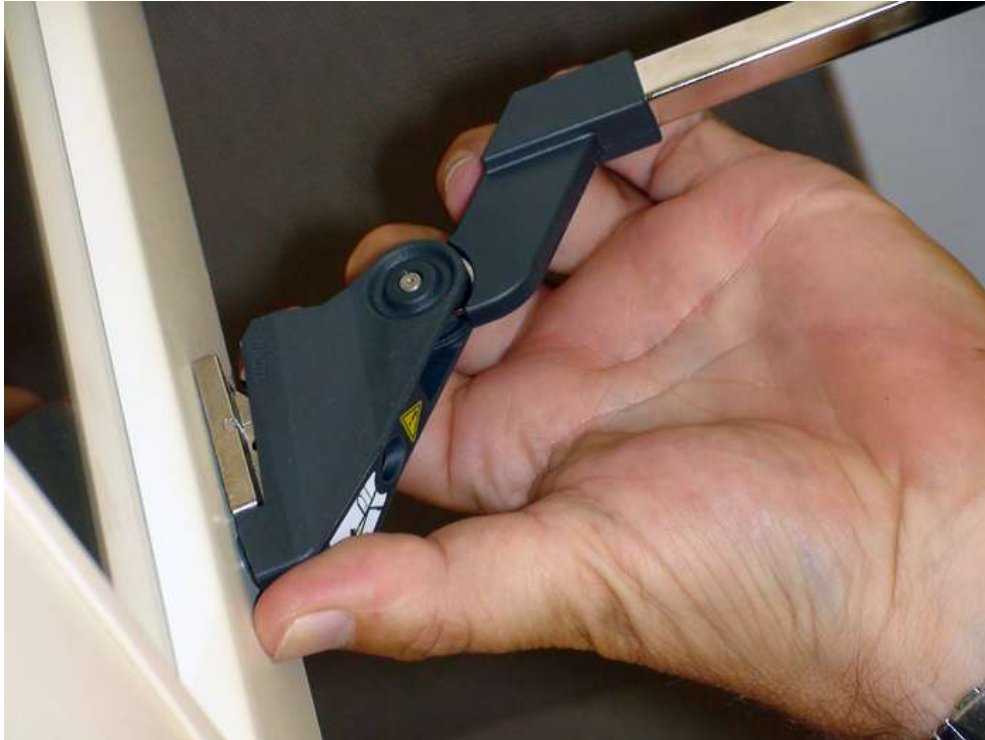
Bild 18. Anclipsen des Hochfaltklappenbeschlages.
