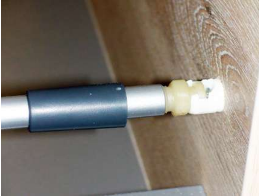
Bild 23. Abdeckkappe auf Relingstange zur Frontbefestigung schieben.
