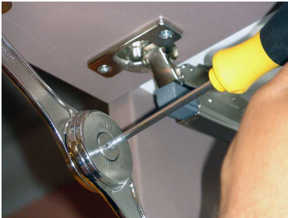
Bild 17. Scherenklappenbeschlag Bremse einstellen.
